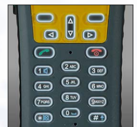
Robustes, schlagfestes Gehäuse, beleuchtete Tasten mit guter Abgrenzung für Handschuh-Bedienung
